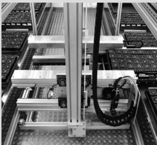
Automatisierte Klimakammer zum Transport von Pflanzen zur Messung von Chlorophyllfluoreszenz und Blattflächen in hohem Durchsatz
