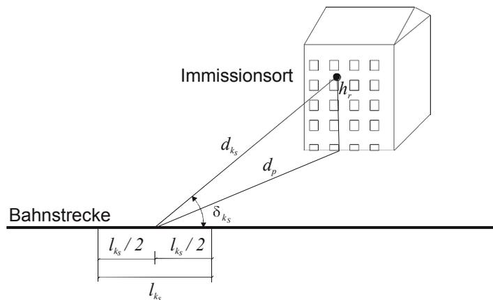
**Bild 2: Definition des Winkels  $\delta_{k_S}$  an einer Bahnstrecke**
