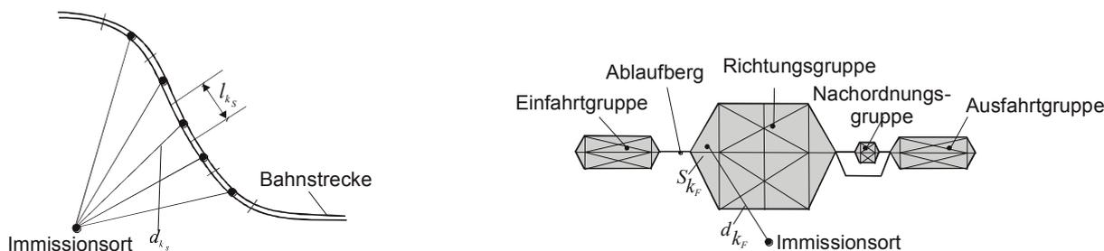
**Bild 1: Beispiele für die Zerlegung von Linien- und Flächenschallquellen in Teilstücke und Teilflächen**
